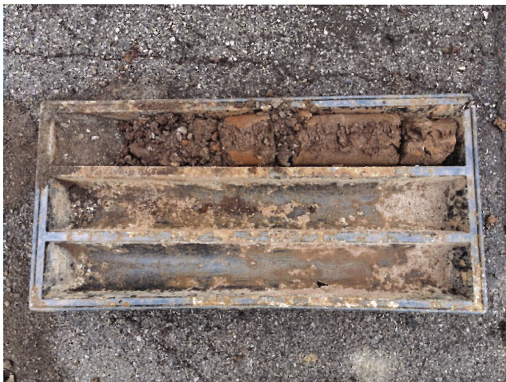
V4 (ul. Zbrojničná) 0,00 – 0,08 m asfalt 0,08 – 1,00 m hnedý íl tuhý – mäkký štrkovitý
